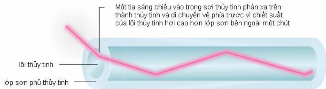
Hình 2. Kích cỡ sợi quang chừng 125 micromet. Lõi sợi thường có đường kính khoảng 10 micromet, nhỏ hơn một sợi tóc người. Ánh sáng hồng ngoại với bước sóng 1,55 micromet mang lại sự thất thoát thấp nhất và ngày nay được dùng trong truyền thông quang học.
