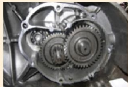
Hình 24.2. Hộp số xe máy
