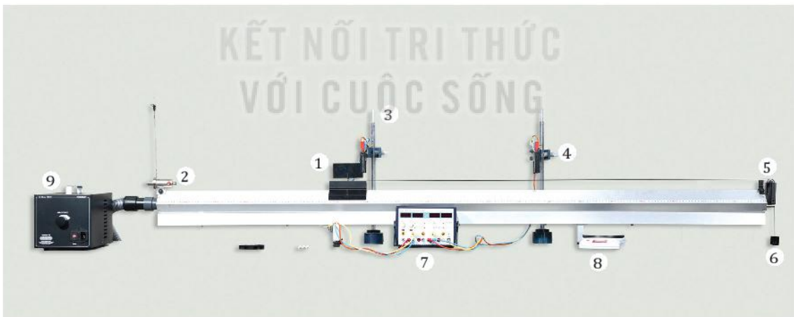
Hình 15.2. Thí nghiệm minh họa định luật 2 Newton
