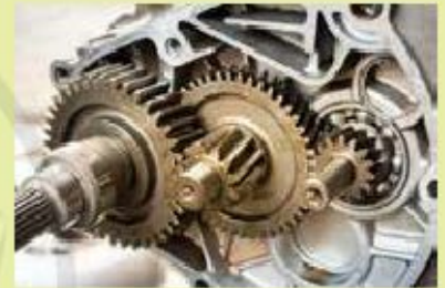
Hình 1.8. Hộp số xe máy
