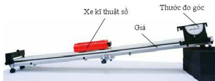
Hình 1.5. Đo tốc độ của xe (dùng xe kĩ thuật số)
