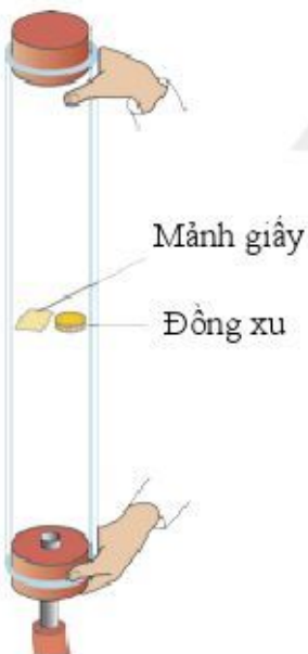
Hình 2.5. Thí nghiệm vật rơi trong bình được hút khí
