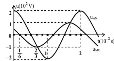
**Câu 161. (ĐH 14):** Đặt điện áp  $u = 180\sqrt{2} \cos \omega t$  (V) (với  $\omega$  không đổi) vào hai đầu đoạn mạch AB (hình vẽ). R là điện trở thuần, tụ điện có điện dung C, cuộn cảm thuần có độ tự cảm L thay đổi được. Điện áp hiệu dụng ở hai đầu đoạn mạch MB và độ lớn góc lệch pha của cường độ dòng điện so với điện áp u khi  $L = L_1$  là  $U$  và  $\varphi_1$ , còn khi  $L = L_2$  thì tương ứng là  $\sqrt{8}U$  và  $\varphi_2$ . Biết  $\varphi_1 + \varphi_2 = 90^\circ$ . Giá trị U bằng:
