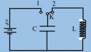
**Câu 10.** Cho mạch điện như hình vẽ:  $C = 500 \text{ pF}$ ;  $L = 0,2 \text{ mH}$ ;  $E = 1,5 \text{ V}$ , lấy  $\pi^2 = 10$ . Tại thời điểm  $t = 0$ , khoá K chuyển từ (1) sang (2). Thiết lập công thức biểu diễn sự phụ thuộc của điện tích trên tụ điện C vào thời gian.
