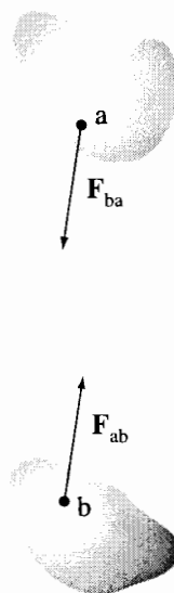
Hình 4-6. Định luật thứ ba của Newton. Các vật a và b tác dụng các lực lên nhau. Theo định luật thứ ba của Newton, các lực này bằng nhau và ngược hướng : F_{ab} = -F_{ba} . Trên hình vẽ các lực này được chỉ ra như các lực hút : F_{ab} hướng vào a, F_{ba} hướng vào b.
