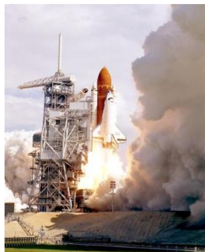
c/ Tên lửa hoạt động bằng cách đẩy khí cháy ra phía sau. Định luật III Newton nói rằng nếu tên lửa tác dụng một lực ra phía sau lên không khí, thì không khí phải tạo ra một lực bằng như vậy tác dụng lên tên lửa. Động cơ tên lửa có thể hoạt động ở trên bầu khí quyển, không giống như máy bay cánh quạt và phản lực, chúng hoạt động bằng cách đẩy không khí xung quanh.
